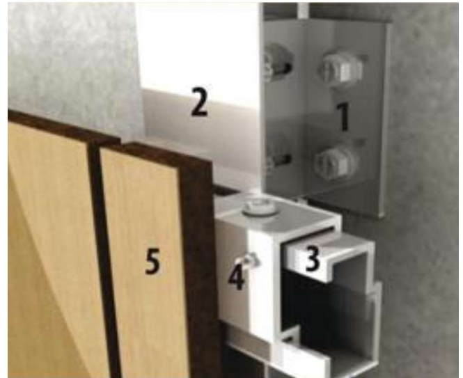
Figura 1.3.: Panelex, sistema fijación oculta con perfilera de cuelgue
